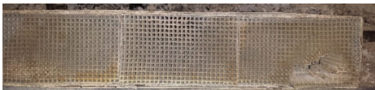
Exemple de masquage de chambre de combustion
